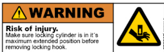
Afbeelding45. Waarschuingssticker op vergrendelcilinder.
